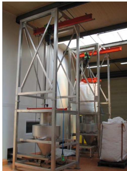
STATION DE VIDANGE EN INOX
