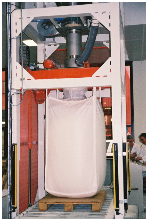
STATION DE REMPLISSAGE EN ACIER PEINT
